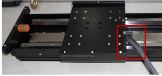
Abb. 6.7: Verlängerungsleitung ist nicht in die Kabelkette eingelegt
