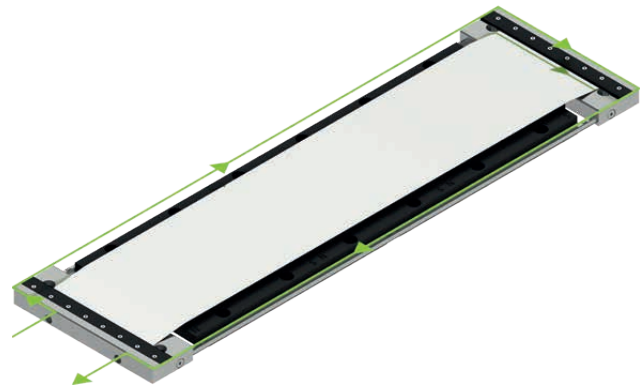
Abb. 6.7 Kühlkreislauf der Sondervariante der Stator-Kühlung
