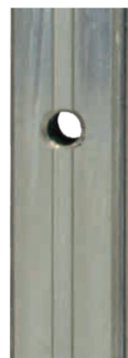
Rail (non chargé) avec revêtement CZS – après 99 heures de test de brouillard salin (selon DIN ISO 9227)
