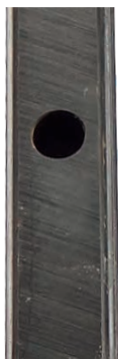
Rail (non chargé) avec revêtement CCB après 24 heures de test de brouillard salin (selon DIN ISO 9227)
