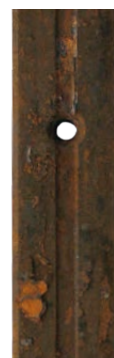
Rail sans revêtement – après 4 heures de test de brouillard salin (selon DIN ISO 9227)
