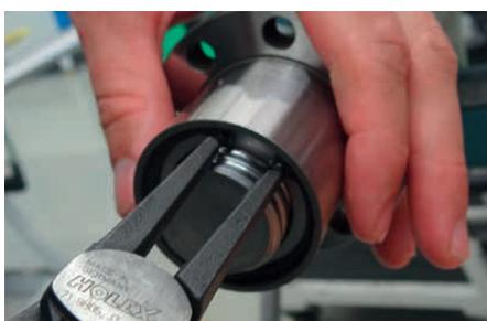
Abb. 4.9 Entfernen des Sicherungsringes
