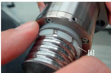
Abb. 4.15 Entfernen des Finger-Abstreifers
