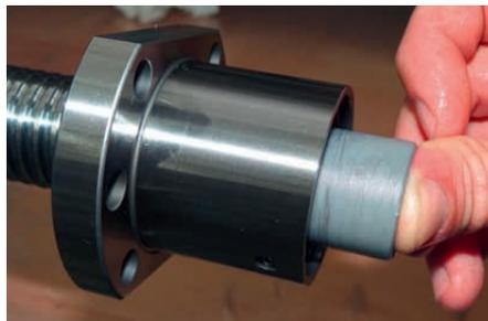
Abb. 4.11 Demontage der Mutter mit Hilfe einer Montagehülse
