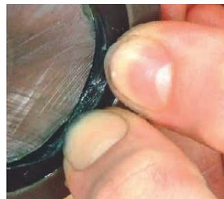
Abb. 4.7 Fixieren des Abstreifers während des langsamen Aufdrehens der Mutter auf die Spindel
