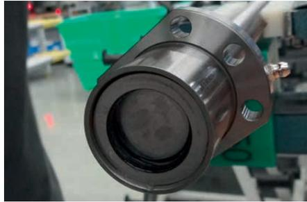
Abb. 4.10 Entfernen des Blechrings
