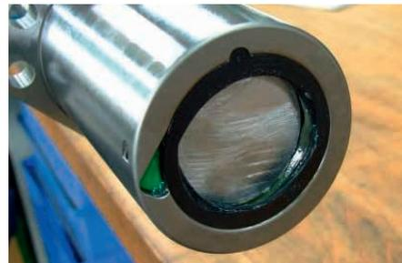
Abb. 4.6 Aufdrehen der Mutter mit Abstreifer auf die Spindel
