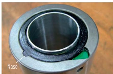
Abb. 4.4 Vor der Montage korrekten Sitz der Abstreifer sicherstellen
