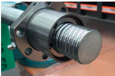
Abb. 4.8 Mutter am Ende der Spindel
