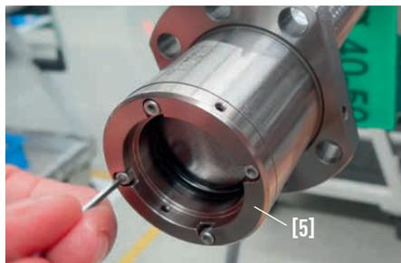
Abb. 4.16 **Abschrauben des Abstreifer-Gehäuses**
