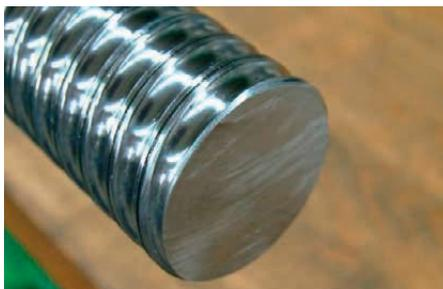
Abb. 4.3 Spindelende vor der Montage des NBR-Abstreifers
